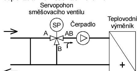
V poloze zavřeno prochází voda směrem B⇒AB, vstup A je uzavřen. V poloze otevřeno prochází voda směrem A⇒AB, vstup B je uzavřen.
